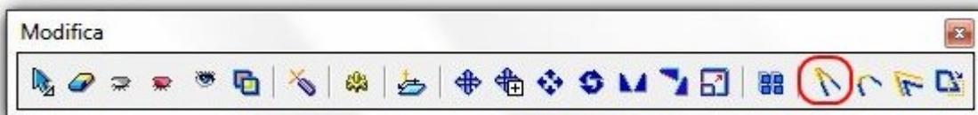
**Nota:** per costruire un muro lungo una direzione non parallela agli assi coordinati, ci aiuteremo utilizzando una linea di aiuto inclinata di 45 rispetto ad un altro muro; quindi richiamando il comando indicato con il cerchietto rosso, scegliamo la misura dell'angolo in gradi ( ARCPLUS usa solo i sessadecimali ) e il punto di passaggio della linea, che verra disegnata sia a destra che a sinistra:
